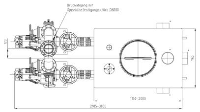
\* Zulaufseite und Zulaufdurchmesser (DN100, DN150, DN200) wählbar Lieferumfang: 1 Zulauf nach Wahl
